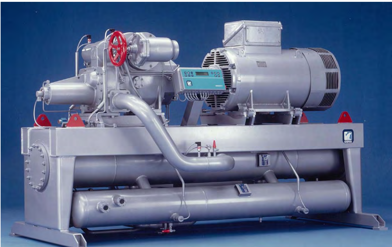
Billede nr. 14: Her et aggregat med Sabroe skruekompressor type SAB 202, som blev den største i programmet.
